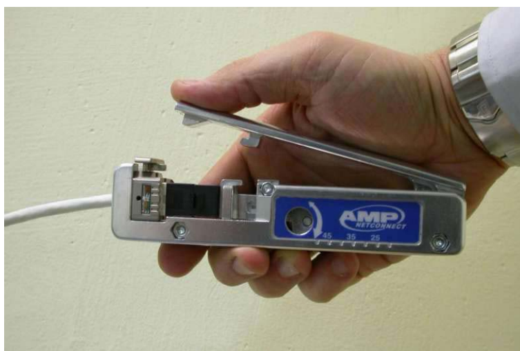
Zarobienie modułu kończy zaciśnięcie narzędzia (z umieszczonym w nim modulem) Efekt to najkrótsze rozploty (<6mm) oraz doskonałe parametry i ich wysoka powtarzalność
